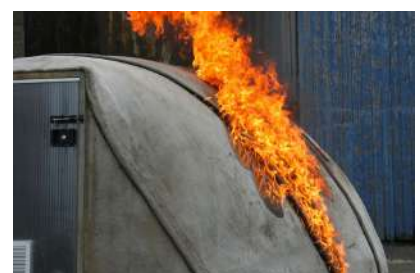
il rifugio costruito in geotessuto CC ha un'ottima resistenza al fuoco
